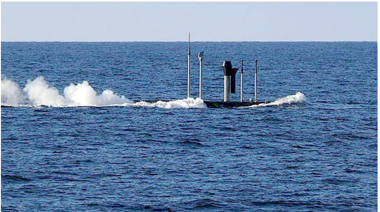
Подводная лодка идёт под РДП (над водой выдвижные устройства, виден шлейф выхлопных газов от работающего дизеля — современный снимок)
