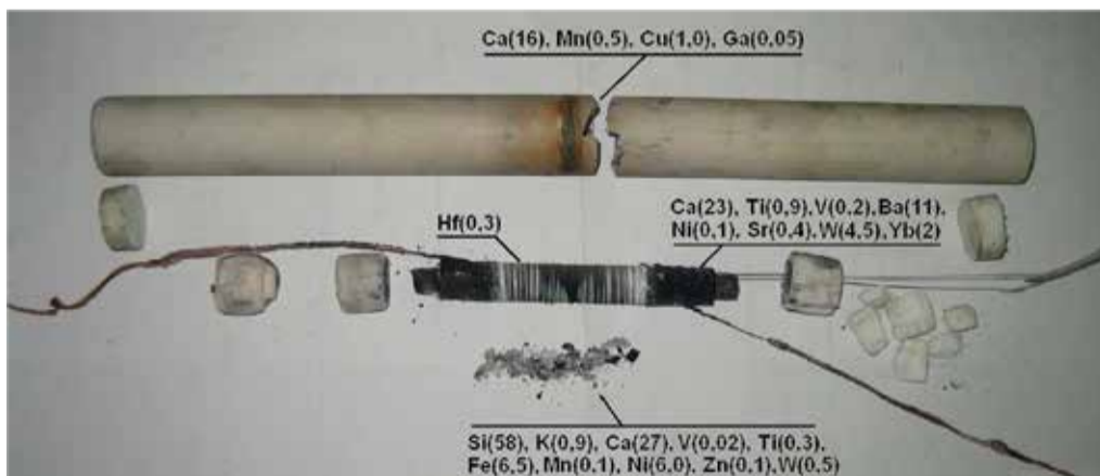
Рис. 11 Общий вид и схема реактора, проработавшего более 7 месяцев [7]
